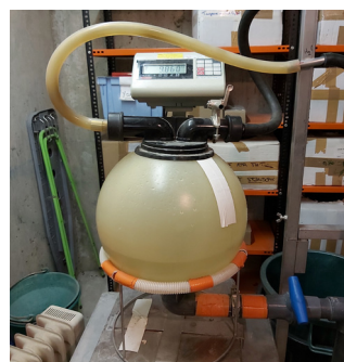
Vérification d'un Tru-test « vache » : ici, le poids de la balance et la relève sur le tube correspondent, l'appareil est fonctionnel.
