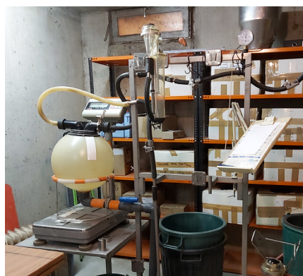
Le banc de vérification répond à des normes de conception strictes et la balance est agréée chaque année.
