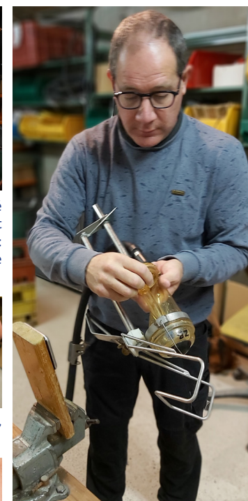
Les joints de la coupole et du tube sont changés chaque année à cette occasion et les tuyaux à lait tous les 3 ans (ce qui équivaut à 400 mètres de tuyaux par an !).
