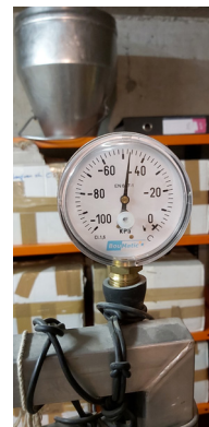
Le manomètre de vide doit être positionné à 48 KPA.
