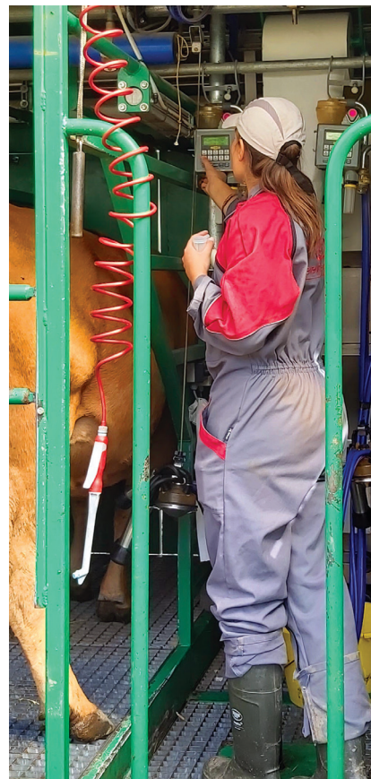
Le Lactocorder est utilisé lors des pesées dans les groupements pastoraux afin d'enregistrer les données d'élevages différents sur une même traite. Il permet simultanément la mesure et la prise d'échantillon de lait.
